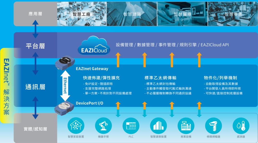
EAZI-net底層傳輸架構, 是基於Ethernet發展的高效率、彈性的I/O擴展技術, 它提供一個全新的I/O擴充模式, 不需要IP定址及管理, 可快速進行安裝佈署, 透過標準乙太網路將資料上傳雲端。
